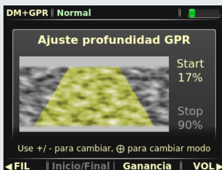
Configuración individual de GPR del punto de inicio y parada
